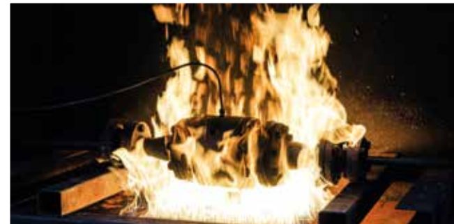
Foto Fire Safe Test – BU: Fire-Safe-Tests gehören bei einigen Hochleistungsarmaturen zum Standard.
