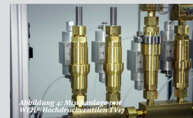
Abbildung 4: Mischanlage mit WEH® Hochdruckventilen TV17
