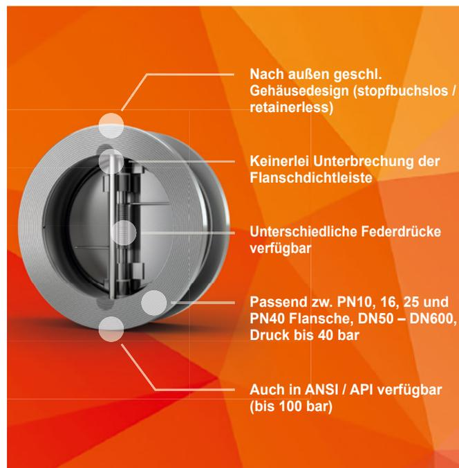
Abbildung: 916 Doppelflügelrückschlagklappe, high-end Ausführung
