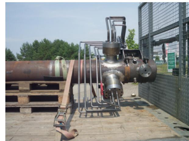
Bildunterschrift: Auslieferung zum Glühen eines der insgesamt zwei 6m langen Dampfrohre mit integriertem Thermoschockrohr inklusive Rohrbündel. Quelle: TEC artec
